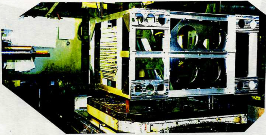
A5052 衛星荷重試験台 850x1450
