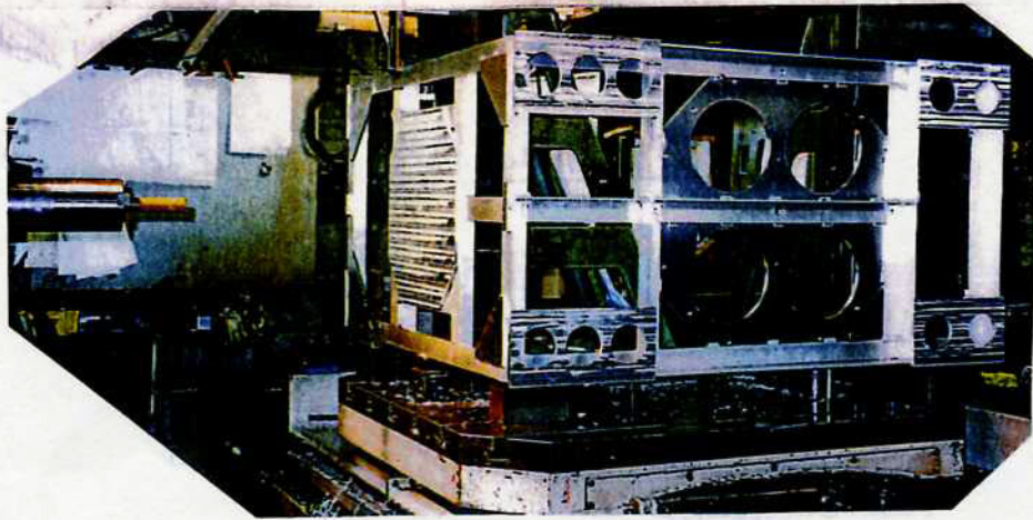
A5052 衛星荷重試験台 850x1450
