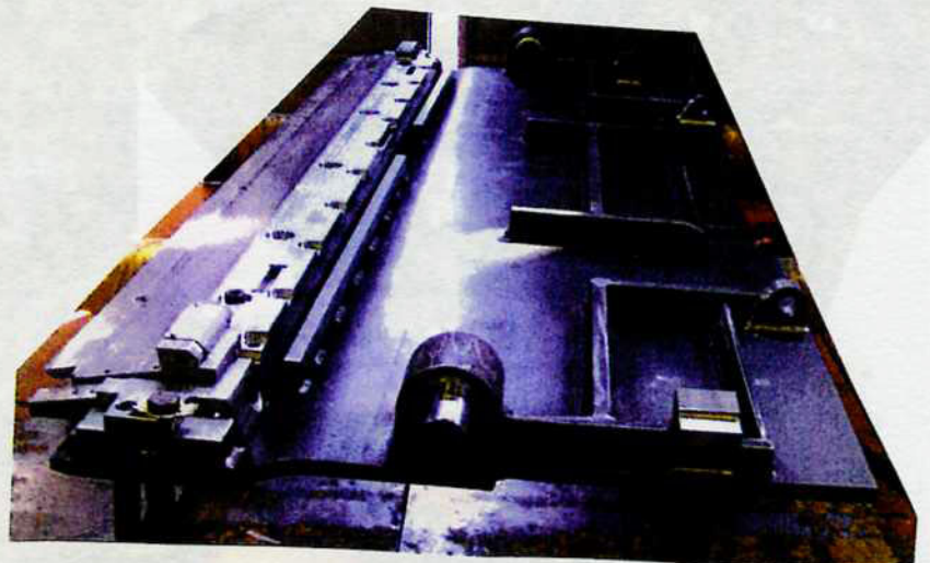
SS400 + Sus 304 溶接及機械加工
